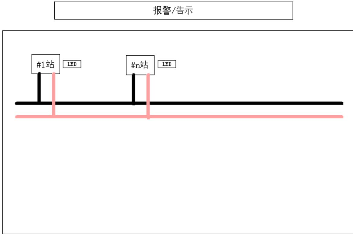
$2m \times 0.37m$ ，作用是报警和告示。综合显示幕上固化热网系统图，其上嵌入 LED 动态显示各个换热站所需热量以及所供热量。图样如下所示：
