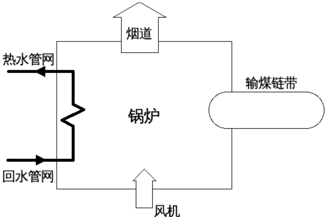
通过图示，锅炉系统的热交换控制和热交换站（见热交换站系统设计）是一样的，额外增加了燃烧控制，可以通过调节风量和输煤量达到燃烧的控制。
